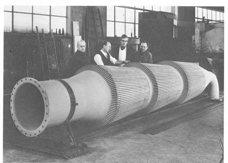
Fig. 9. — Crépine Doucet hydromat filter en construction dans les ateliers de Carouge.
