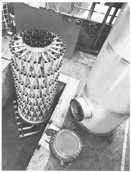
Fig. 11. — Groupe mixte filtre à treillis-hydrocyclones pour le prétraitement de l'eau.
