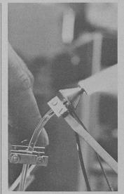
La recherche et le progrès : les ma-tériaux nouveaux permettent de trouver des solutions nouvelles. Les applications des céramiques piézo-électriques sont très diversifiées. Elles servent à réaliser des touches, des filtres d'ondes électriques, des télémètres à ultrasons ou des pulvé-risateurs de liquide. La nébulisation des liquides rend les brûleurs à mazout et les inhalateurs plus efficaces.
