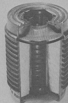
dans le moteur ainsi que le soufre dans l'huile provoquent une réaction. Il en découle un acide soufré. Le filtre, qui absorbe l'eau de condensation, empêche ainsi cette réaction néfaste qui provoquerait la corrosion.
