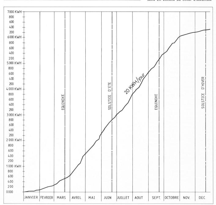
Fig. 2. — Energie solaire reçue.
