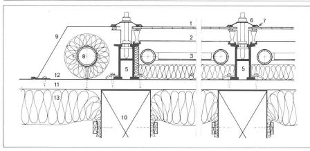
Fig. 4. — Coupe sur les capteurs solaires Helionox toiture (Bersier SA, Bulle).
