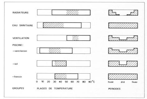
Fig. 3. — Fonctionnement des différents groupes de l'hôpital : plages de température et périodes. Les zones hachurées représentent les plages dans lesquelles la plus grande quantité d'énergie est consommée.
