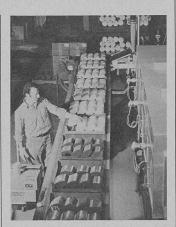
Vue partielle de l'installation de production de catalyseurs pour les gaz d'échappement des automobiles dans l'usine de la Degussa à Rheinfelden. L'installation a une capacité d'environ I million de catalyseurs par an.
