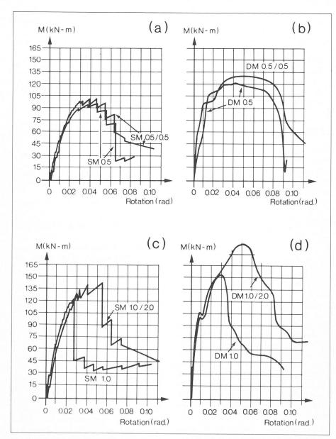
Fig. 9. — Comparaison des courbes moment-rotation sous charge axiale V constante et sous moment  $M_V$  variable (voir fig. 2, réf. 6). Nomenclature des éléments : SM ou DM indique l'application d'un moment statique, respectivement dynamique. Le premier nombre suivant ces lettres indique le pourcentage d'armature de flexion ; le second est la section totale d'armature de cisaillement (1 pouce $^2=645~\mathrm{mm}^2$ ).
