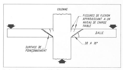
Fig. 1. — Rupture par poinçonnement habituellement rencontrée lors des essais.
