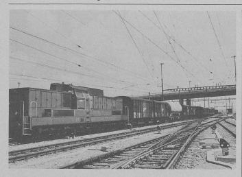
de fréquence et de tension variables, était généré par un redresseur et un onduleur pour entraîner des moteurs asynchrones à cage d'écureuil faisant fonction de moteurs de traction. Le rêve de tout constructeur de locomotives, la locomotive équipée d'un moteur asynchrone léger et indestructible, était devenu une réalité!
