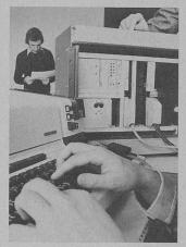
Le microcalculateur MC 210 peut bénéficier d'une programmation personnalisée en assembleur, mais l'utilisation du langage évolué PL/M est également possible. Pour les applications industrielles, Siemens a développé le langage de programmation STEM, basé sur le langage STEP 3 pour automates à programme enregistré.
