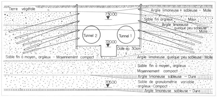
Fig. 1. — Profil géotechnique et coupe type du puits (20 × 20 × 14,50 m) avec le départ des deux tunnels et la position des tirants.
