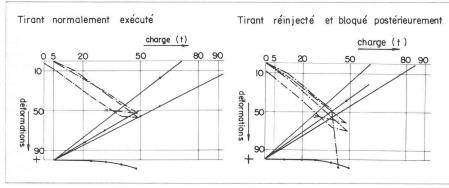
Fig. 5. — Essais de réception: mesure de la déformation permanente et comparaison des déformations élastiques avec les droites a et b.
