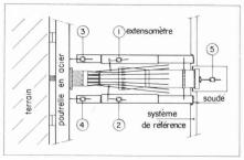
Fig. 2. — Mesure des déformations au moyen de 5 extensomètres.
