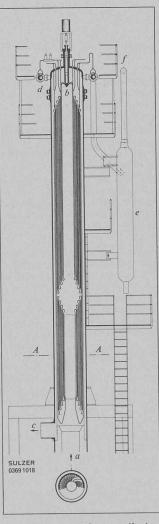
Refroidisseur de gaz de processus pour pressions et températures élevées, construit d'après le principe de l'évaporateur monotubulaire Sulzer.
