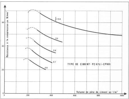
Fig. 4. — Résistance à la compression en fonction du volume de pâte (d'après Schlotmann).
