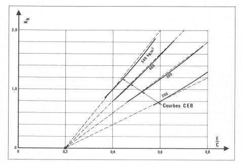
Fig. 8. — Paramètre K<sub>b</sub> en fonction du rapport E/C pour différents dosages (d'après CEB-FIP).
