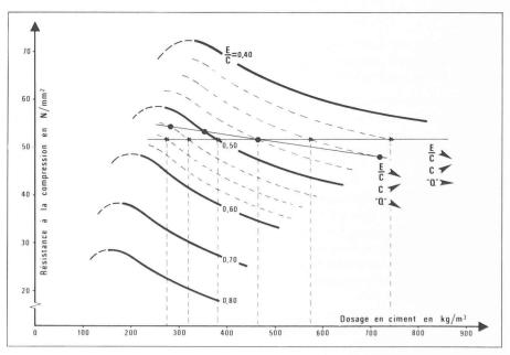
Fig. 5. — « Qualité » du béton en fonction du dosage et du rapport E/C.
