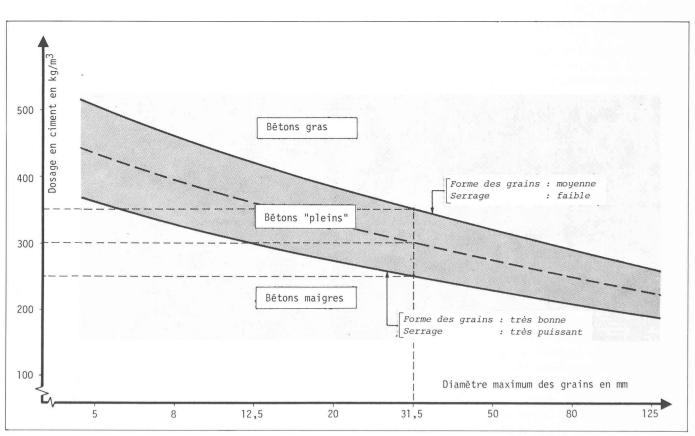
Figure 1. — Dosage en ciment en fonction du diamètre maximal des grains.
