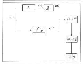
Fig. 1 — Principe de la détermination de la fonction de transfert G(p) du système S par l'application analogique de la transformation de Laplace.  $u(t) = \acute{e}chelon \ rectangulaire \ unitaire.$
