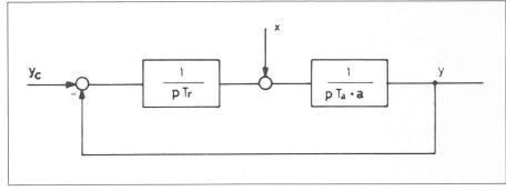
Fig. 4. — Schéma fonctionnel très simplifié du réglage de vitesse d'une centrale électrique en marche isolée.
