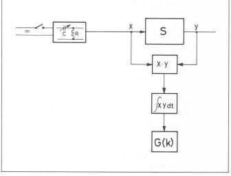
Fig. 2. — Principe de la détermination de la fonction de transfert G(k) par l'auscultation du système S au moyen d'une fonction exponentielle et par le calcul de sa covariance  $Txy^2 = \int_0^2 xydt$ .
