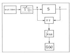
Fig. 3. — Principe de la détermination de la fonction de transfert  $G\left(k\right)$  à l'aide d'un bruit blanc filtré au moyen d'un filtre passe bas.
