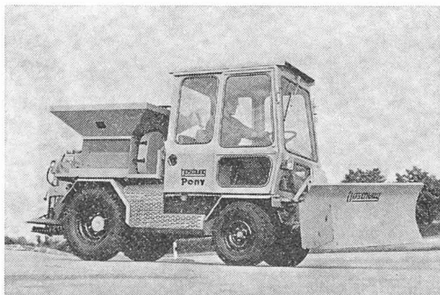
Le Pony Boschung équipé d'un chasse-neige et d'un distributeur de produit de dégel.
