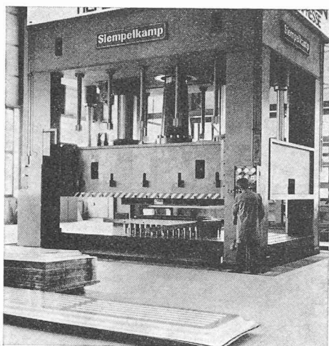
Fig. 2. — Presse à emboutir de 1600 tonnes (installée chez Schmidlin, Aesch/BL).
