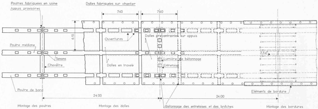
Fig. 3. — Schéma d'exécution du tablier.
