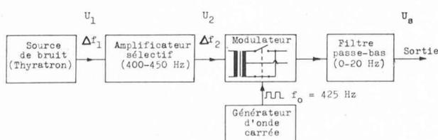
Fig. 1. — Schéma bloc du générateur de fonction aléatoire.
