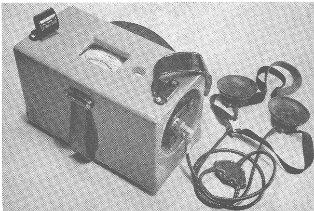
Détecteur portatif pour la mesure de rayonnements radio-actifs dans le terrain. (Fabrication LANDIS & GYR S. A., Zoug).
