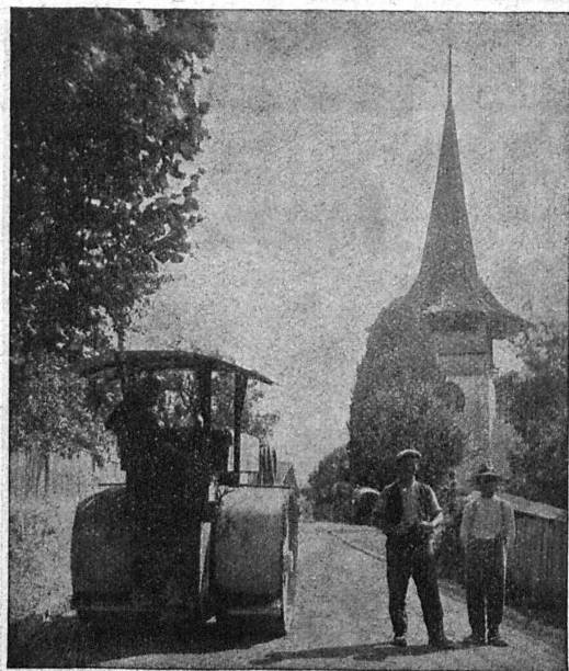
Cet "Advance" mazout 12 tonnes a travaillé pendant 2 saisons sur les routes escarpées de l'Oberland.
