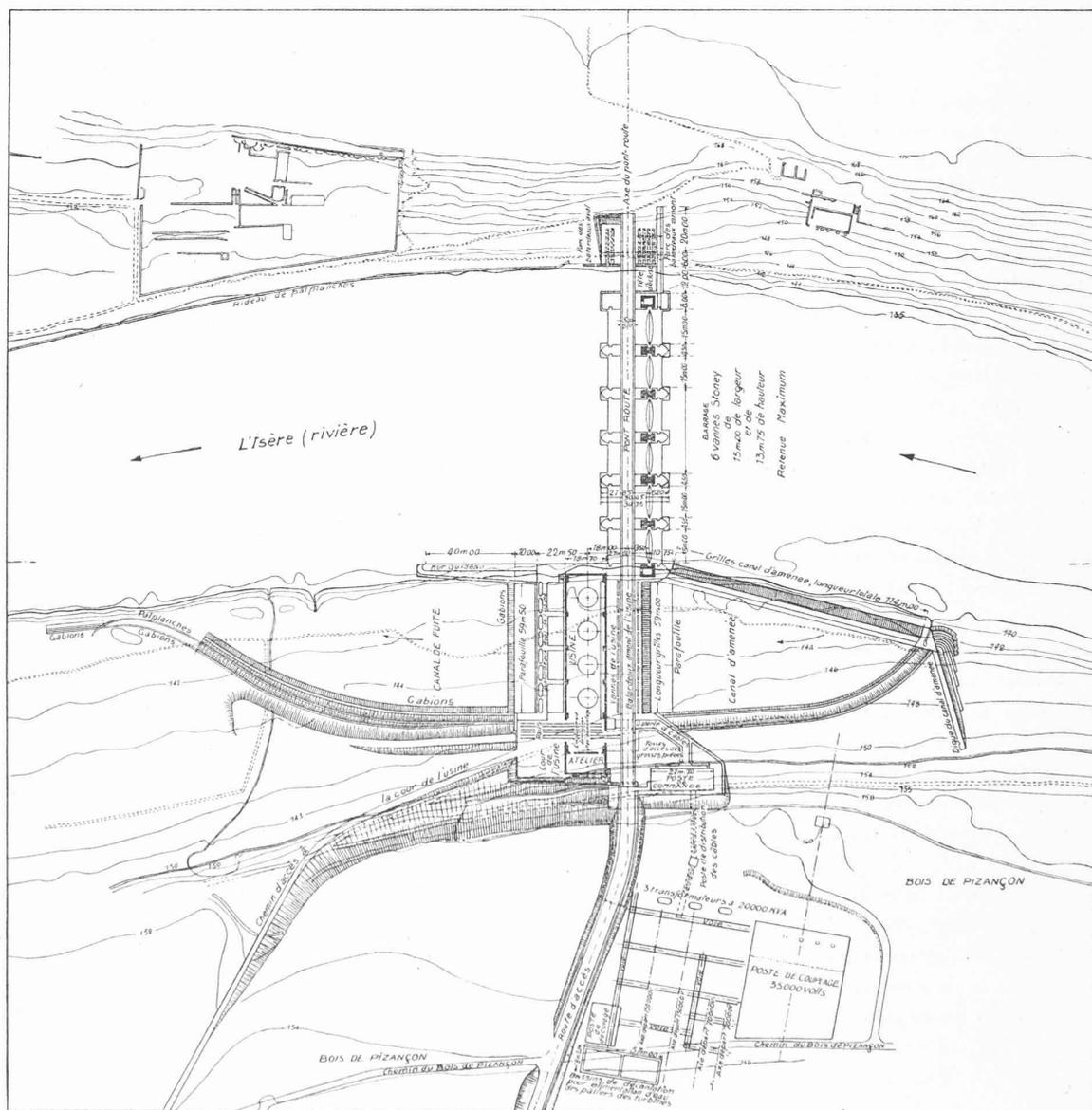
Fig. 1. — Plan d'ensemble de l'usine de Pizanzon. — Echelle 1 : 3000.
