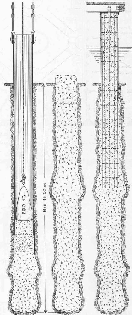
Fig. 2. — Enfoncement du tuyau et construction de pilots.
