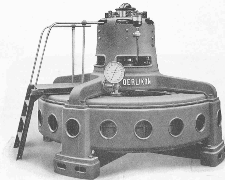
Fig. 1. — Alternateur de 250 K. V. A., 28 pôles, pour la centrale d'Erlenholz.
