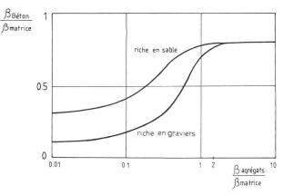
Fig. 1. — Relation entre la résistance à la compression sur cube des agrégats, de la matrice et du béton [8].
