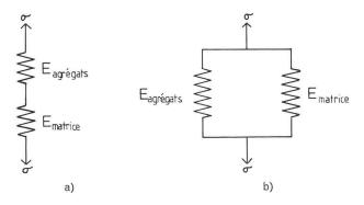
Fig. 3. — a) Contrainte homogène.
