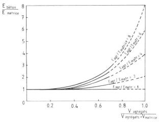
Fig. 2. — Relation entre le module d'élasticité du béton et le rapport volumique de ses composants [8].
