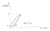
Fig. 4. — Domaine de sollicitation des éprouvettes de béton.
