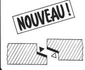
Lors de la construction collecteurs d'eaux usées, utilisez le tuyau en béton avec bandes plasto-élastiques
