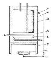
Fig. 10. — Chaudière « Vacotin »: une source de chaleur (1) chauffe une faible quantité de liquide (2) contenue dans un espace sous vide (3) et produit ainsi une vapeur saturante (4) qui transmet sa chaleur en se condensant au contact des parois du serpentin de chauffage (5) et du ballon d'eau chaude (6). La chaudière est en dépression par rapport au milieu ambiant. La commande se trouve en (7) (schéma Ruhrgas AG).
