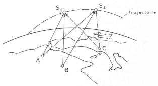
Fig. 22. — Utilisation des satellites en géodésie.
