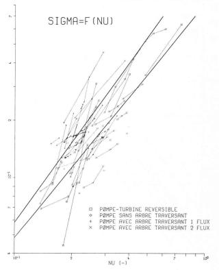
Fig. 19. — Relations statistiques entre le chiffre de cavitation  $\sigma$  ( $\bar{\sigma}_{ad}$  dans le texte) et le chiffre de rotation  $\nu$  ( $\nu_R$  dans le texte) de pompes et pompes-turbines.
