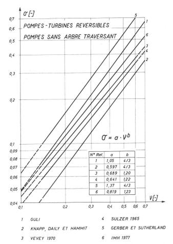
Fig. 20. — Comparaison de relations statistiques entre le chiffre de cavitation  $\sigma$  et le chiffre de rotation  $\nu$  de pompes.
