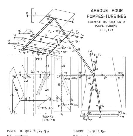
Fig. 23. — Exemple d'utilisation de l'abaque pour la détermination des caractéristiques d'une pompe-turbine réversible (e = 1; f = 1). Cet exemple ne comprend pas la détermination des dimensions absolues pour
