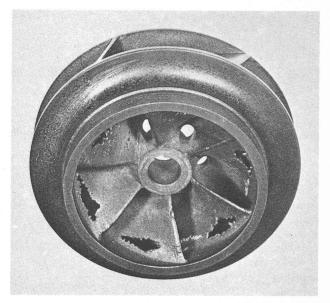
Fig. 17. — Dégâts causés par la cavitation sur une roue de
