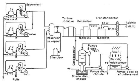
Fig. 5. — Diagramme schématique de la centrale géothermique de Onuma [18].
