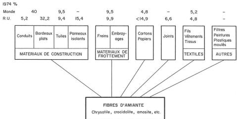
Fig. 2. — Utilisations de l'amiante.
