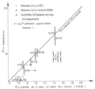
Fig. 6. — Vagues significatives : comparaison entre prévisions et mesures.
