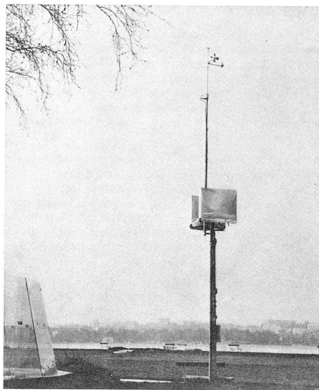
Fig. 3. — Capteur de vent NEZ. A gauche, les vitres protégeant les bassins.
