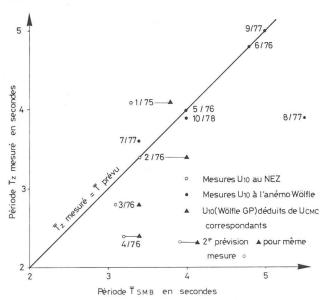
Fig. 7. — Périodes  $\overline{T}_z$ : comparaison entre prévisions et mesures.
