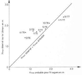
Fig. 10. — Creux maxima: comparaison entre prévisions et mesures.
