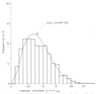
Fig. 8. — Probabilités théorique et expérimentale des amplitudes normalisées des vagues (voir aussi fig. 12).
