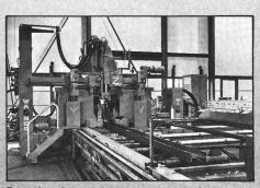
Banc de sciage et de perçage automatique.
