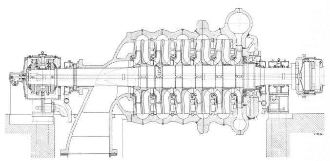
Fig. 3. — Coupe axiale d'une pompe d'accumulation à plusieurs étages (e=6; f=1).
