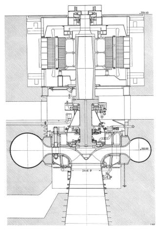
Fig. 6. — Coupe axiale d'une pompe-turbine réversible avec distributeur-diffuseur mobile (e = 1; f = 1).
