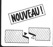
Lors de la construction de collecteurs d'eaux usées, utilisez le tuyau en béton avec bandes plasto-élastiques
