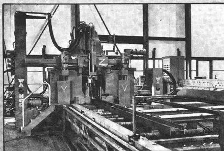
Banc de sciage et de perçage automatique.
