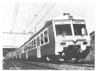
Fig. 11. — Confort et vitesse sont les éléments les plus évidents sur lesquels il convient de se pencher pour augmenter l'attractivité du chemin de fer. A gauche: composition de voitures à caisse inclinable dans les courbes, climatisées (photo CFF). A droite: nouvelle rame de banlieue RABDe 8/16 en alliage léger, à commande par thyristors; démarrage et accélération sans à-coups, grâce à des techniques avancées (photo BBC).
