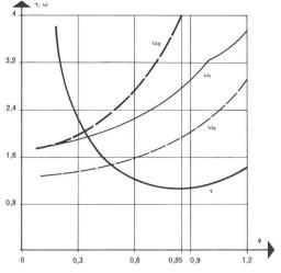
Fig. 9. — Durée de parcours relative et énergies relatives consommées en fonction du rapport de transmission.
