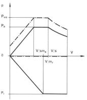
Fig. 8. — Caractéristiques de puissance d'un propulseur thermique.
