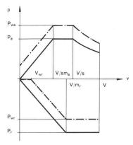
Fig. 7. — Caractéristiques de puissance d'un propulseur économique.
