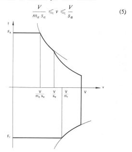
Fig. 1. — Poussée spécifique en fonctionde la vitesse d'un propulseur de type série.
