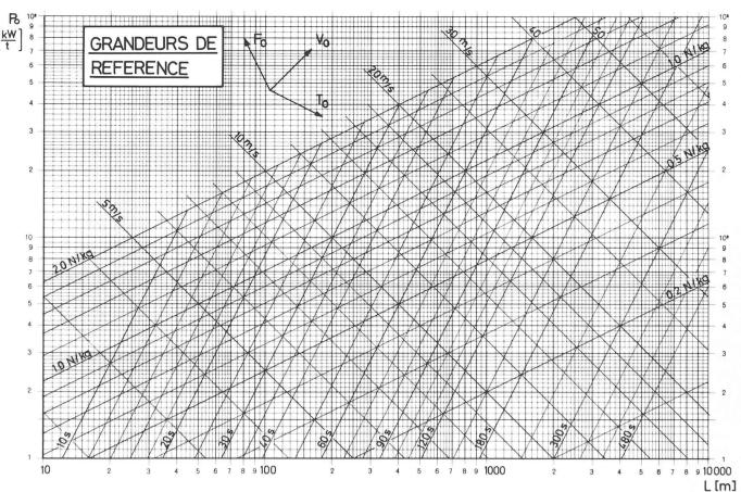
Fig. 5. — Diagramme des grandeurs de référence correspondant à un propulseur à poussée constante.
