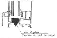
Fig. 33. — Cadre de fenêtre métallique.
