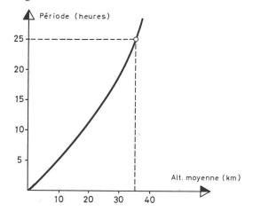
Fig. 14. — 3e loi de Képler pour un satellite terrestre.
