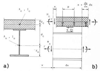
Fig. 1. — Notations employées pour l'analyse de l'interaction incomplète.
