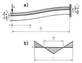
Fig. 6. — Poutre biencastrée sollicitée par une charge ponctuelle au milieu de la travée.
