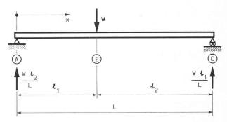
Fig. 2. — Poutre simple sollicitée par une charge ponctuelle.
