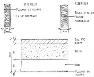
Fig. 6. — Eléments de la construction légère [2].
