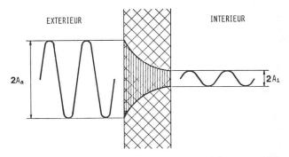
Fig. 3. — Variations de température au travers d'une paroi [2].
