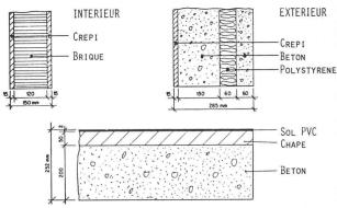
Fig. 7. — Eléments de la construction lourde [2].
