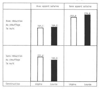
Le tableau 7 montre aussi que même pendant une semaine nuageuse de janvier et pour les deux types de construction, le 40 % de l'énergie de chauffage est fournie par le soleil au travers des fenêtres.
