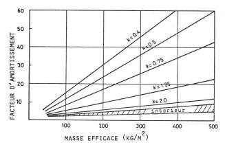
Fig. 4. — Facteur d'amortissement en fonction de la masse efficace et de la valeur K [2].
