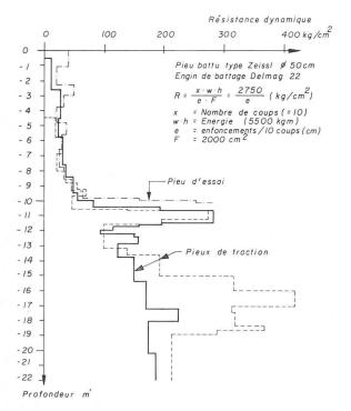
Fig. 3. — Diagramme de battage du pieu d'essai et des deux pieux de traction.
