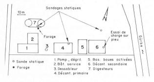
Fig. 1. — Plan de situation des essais avec l'emplacement des sondages.
