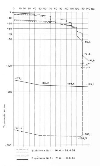
Fig. 5. — Diagrammes charge-tassement.
