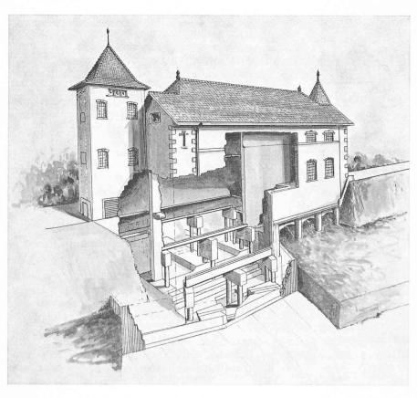
Fig. 6. — Ecorché du bâtiment, reprises en sous-œuvre.
