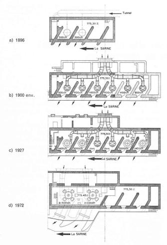
Fig. 2. — Evolution de la disposition des groupes dans la centrale. Coupe en plan au niveau du sol des turbines — cote 775,3 m/mer.
