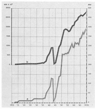
Fig. 4. — Centrales géothermoélectriques. Puissance installée et énergie électrique produite. La puissance installée (a) et l'énergie produite (b) ont accusé en Italie un accroissement continuel. En 1944, les installations géothermiques furent totalement détruites par suite des faits de guerre.
