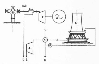
Fig. 9. — Schéma d'installation géothermique à Cycle 3. S = Tête de puits ;  $H_2O = Injection$  d'eau pour le lavage de la vapeur ;  $C_A = Cyclone$  axial ; T = Turbine ; A = Alternateur ; C = Condenseur à mélange ; Tr = Tour de refroidissement ; P = Pompe ;  $A_1 = Compresseur$  ; a) = Décharge du gaz ; b) = Décharge des eaux boriques ; c) = Surplus d'eau.
