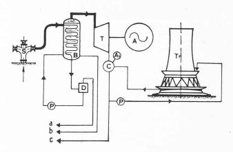
Fig. 8. — Schéma d'installation géothermique à Cycle 2. S = Tête de puits; B = Echangeur de chaleur; T = Turbine; A = Alternateur; C = Condenseur à mélange;  $A_1 = P$ ompe à vide; Tr = Tour de refroidissement; P = Pompe; D = Dégazeur; a) = Décharge du gaz; b) = Décharge des eaux boriques; c) = Surplus d'cau. Des eaux boriques et/ou du gaz peuvent être envoyés aux installations chimiques.
