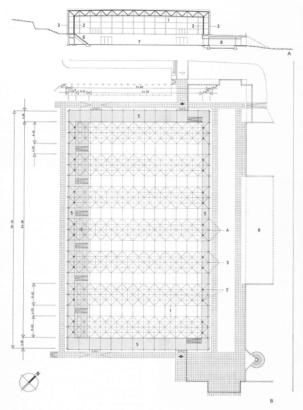
Fig. 3. — Coupe et plan de la halle 1 : 500 (source : Centre suisse de la construction métallique).
