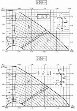
Fig. 9. — Flexion oblique — Diagrammes d'interaction  $m_x/n$ ;  $m_y/m_x = {\rm const.}$
