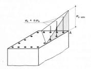
Fig. 1. — Répartition linéaire des contraintes d'après la théorie de l'élasticité dans une section rectangulaire sollicitée en flexion oblique.
