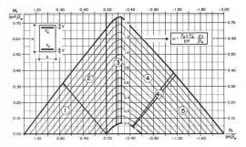
Fig. 7. — Diagramme d'interaction — Flexion composée.
