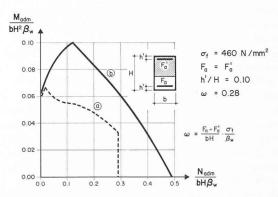
Fig. 2. — Comparaison des efforts admissibles dans une section rectangulaire sollicitée en flexion composée.
