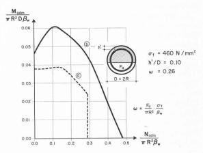
Fig. 3. — Comparaison des efforts admissibles dans une section circulaire.
