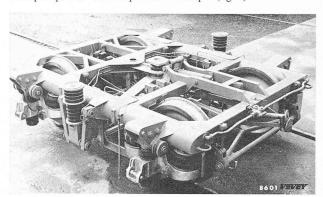
Fig. 1. — Bogie à suspension pneumatique d'une voiture AOMC. Remarquez: la roue dentée du freinage sur crémaillère.
