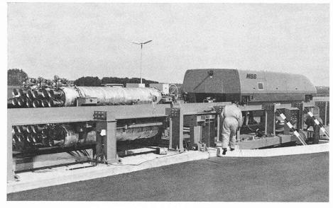
Fig. 15. — Véhicule d'essai à sustentation magnétique MBB. A gauche, chariot propulseur équipé de 6 POHWARO 80 000 d'une poussée maximale totale de 54 tonnes (photo d'usine MBB).
