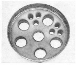
Fig. 11. — Fond arrière d'un propulseur, vu de l'intérieur.
