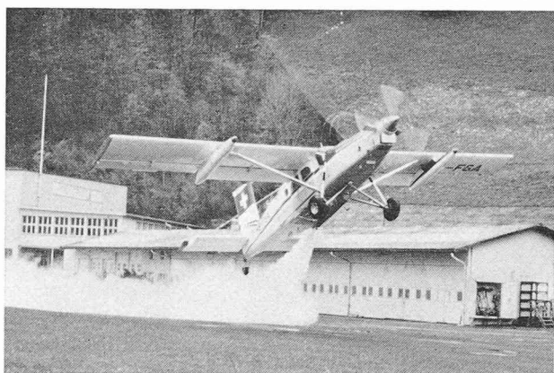
Fig. 8. — Décollage d'un Pilatus Porter équipé d'un propulseur POHWARD 5500 (photo J.-P. Weibel).
