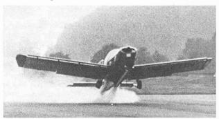
Fig. 7. — Décollage d'un MS-880B « Rallye » équipé d'un propulseur POHWARO 2500 (photo A. Hool).
