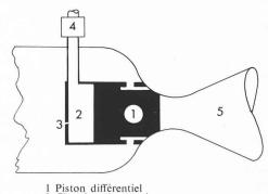
Chambre de pression Orifice d'équilibrage de la pression Electrovalve de mise à l'air libre Tuyère de poussée
