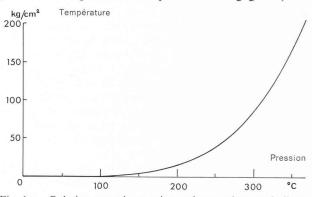
Fig. 1. — Relation entre la pression et la température de l'eau dans un récipient clos.
