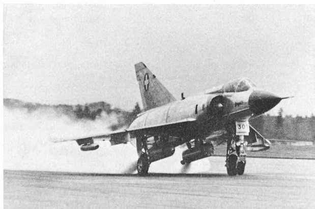
Fig. 6. — Décollage d'un Mirage IIIS équipé de deux propulseurs POHWARO 25 000.
