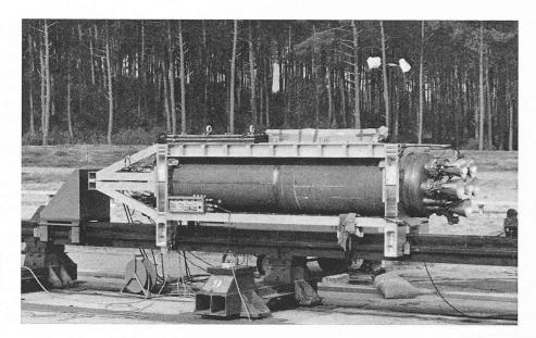
Fig. 14. — Propulseur POHWARO 55 000 sur rail d'essai au Centre d'essais des Landes. Le chariot repose sur quatre patins.
