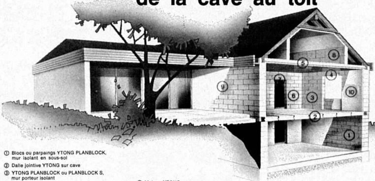
Le système YTONG se compose de blocs, de parpaings, de dalles jointives armées, d'éléments de cloison et de panneaux armés de toiture ; il fait la somme de toutes les caractéristiques essentielles et prévient les risques de dommage.
