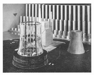
Fig. 5. — Essais en soufflerie aérodynamique.
