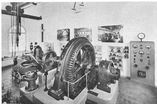
Le groupe préservé ; à gauche, engrenage conique à denture de bois Escher Wyss et à droite, générateur BBC.
