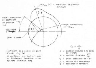
Fig. 1. — Définition des grandeurs caractéristiques de la répartition de pression autour d'un cylindre.
