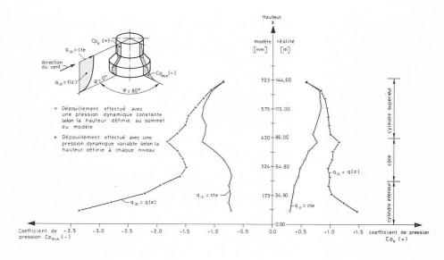
Fig. 8. — Coefficients de pression  $Cp_0$  et  $Cp_{\min}$  en fonction de la hauteur.
