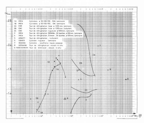
Fig. 3. — Coefficient de pression minimum en fonction du nombre de Reynolds.
