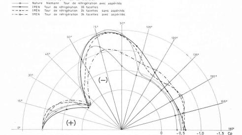
Fig. 9. — Coefficients de pression. Comparaison entre mesures effectuées en écoulement turbulent.
