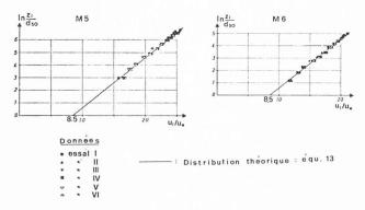
Fig. 4. — Distribution verticale des vitesses adimensionnelles pour les matériaux 5 et 6.
