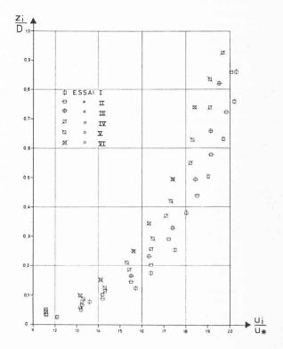
Fig. 3. — Distribution verticale des vitesses adimensionnelles pour le matériau 1 seulement (les autres sont semblables).
