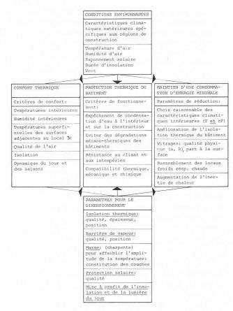
Fig. 7. — Conception d'ensemble de l'isolation thermique.
