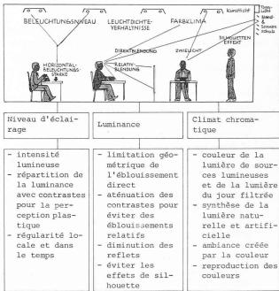
Fig. 8. — Les éléments de la conception de l'éclairage.
