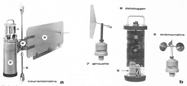
Fig. 3. — Instruments de mesure: a) de courant (à gauche), b) de vent (à droite).
