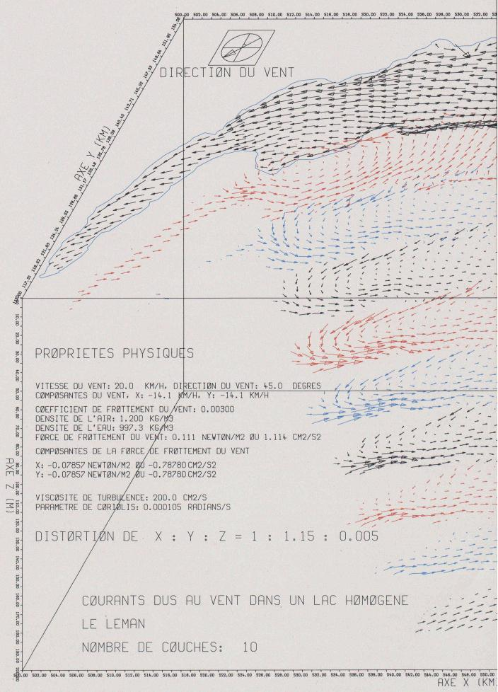
Fig. 2. — Vue synoptique tridimensionnelle du champ de vitesses
