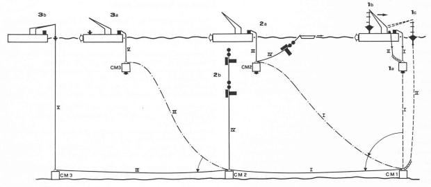
Installation de la balise 3a Immersion du corps mort 3 3b Ancrage de la balise Installation de la station des courantomètres
